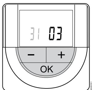
Použitím tlačidiel - alebo + zmeníte hodnotu a stlačením tlačidla OK prejdete na ďalšiu upraviteľnú hodnotu.
